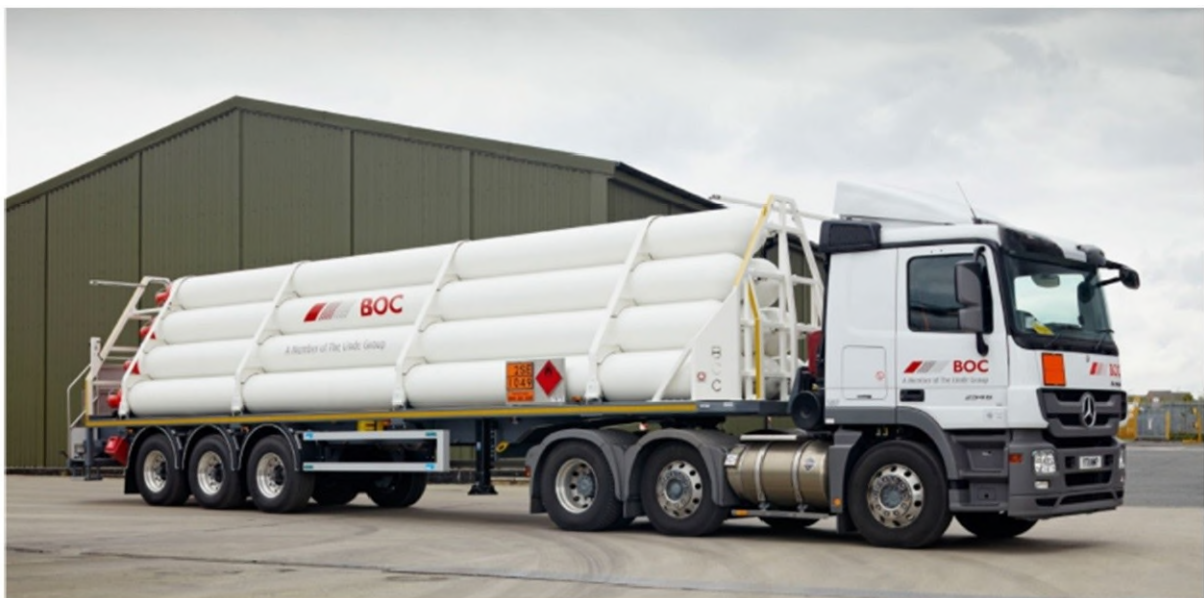
Een tube-trailer met 9 stalen drukcilinders (200 bar) (M-Tech, 2020)
